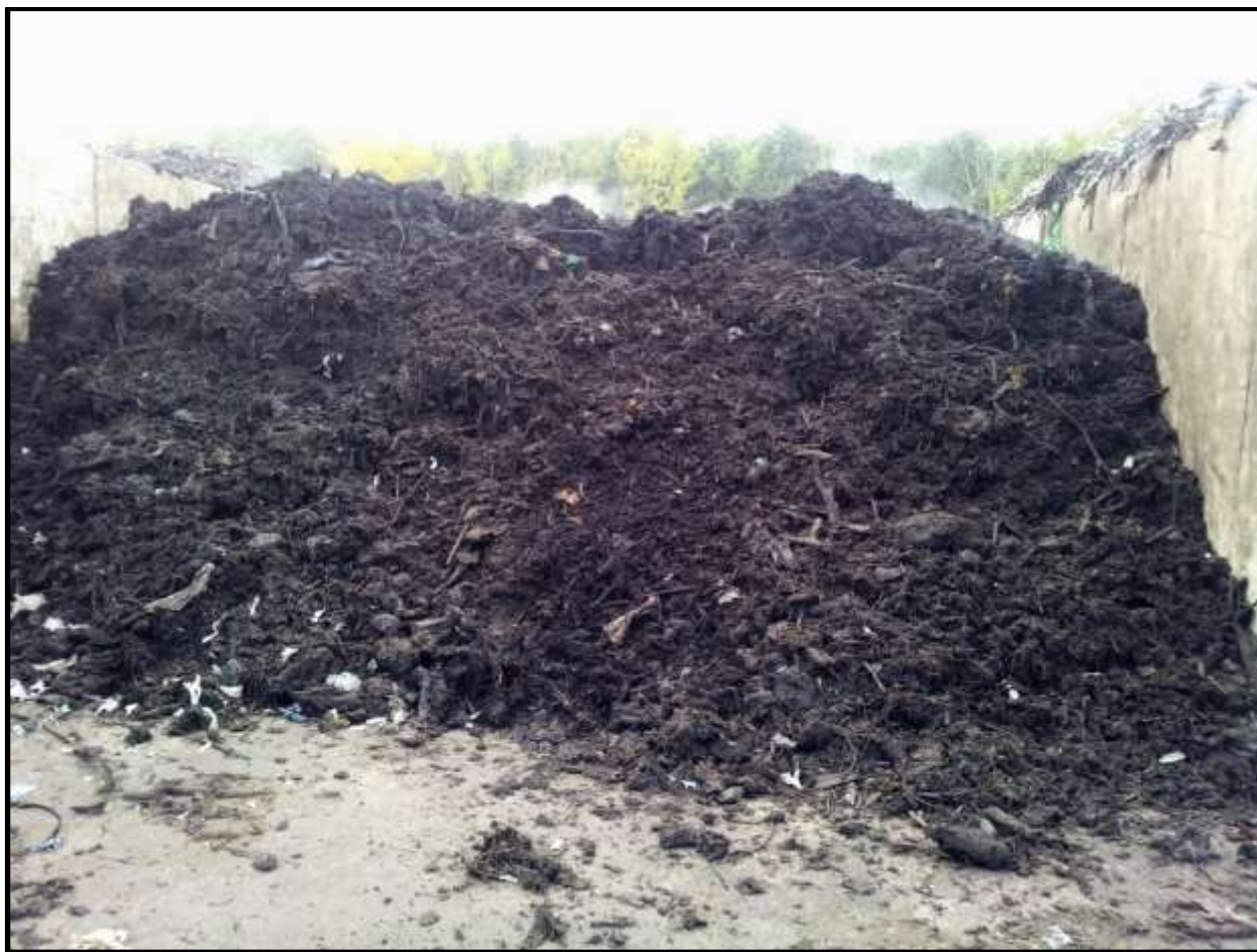
Figur 3. Eftermodning af komposteret biomasse og strukturmateriale før sortering (se evt. Figur 12).
