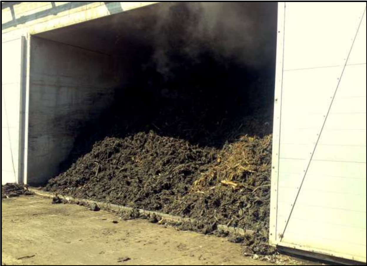
Figur 2. Procesmodul fyldt med blanding af biomasse og strukturmateriale.
